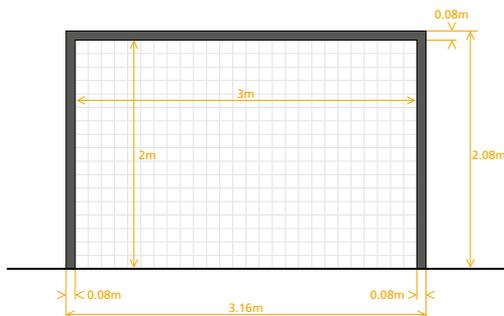
Las porterías deberán disponer de un sistema estabilizador que impida su vuelco. Aunque no deberán estar ancladas al suelo, el peso de la parte trasera de las porterías deberá permitir moverlas sin poner en riesgo la seguridad de los participantes.
